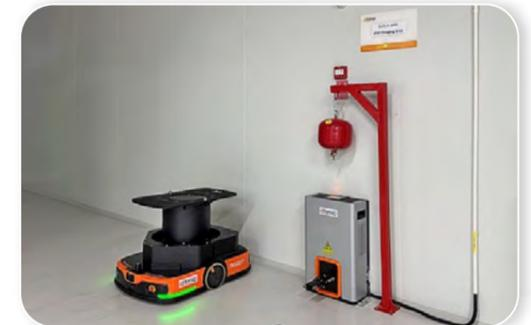
黃石廠導入無人搬運車 AGV 運送產品，減少人工搬運台車產生的工安風險。
